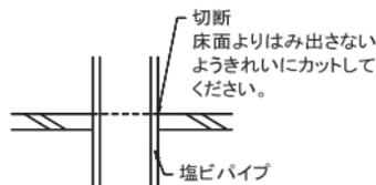
2. 本体差込部と排水管の両側に塩ビ用接着剤を塗布し差し込む。
