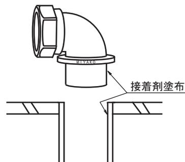
3. 本体からナット、パッキンを外して排水管(塩ビ管40)にナット、パッキンの順に通して下さい。
