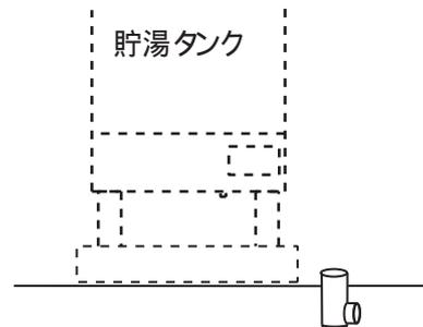
2. 耐熱塩ビ管を配管し、耐熱塩ビ管および横引きソケットに耐熱塩ビ管用接着剤を塗布し接続してください。
