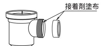
プッシングを接着後、プッシング内面および耐熱塩ビ管 (HTVP40) に耐熱塩ビ用接着剤を塗布し挿入してください。
